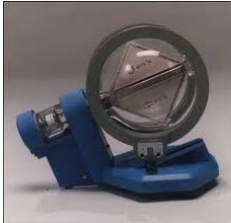
Figura 1 – Tubo de raios catódicos (CRT) usado nesta experiência e bobinas de Helmholtz.
