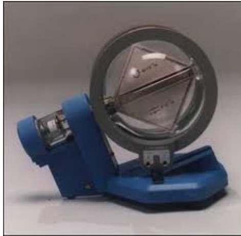
Figura 1 – Tubo de raios catódicos (CRT) usado nesta experiência e bobinas de Helmholtz.
