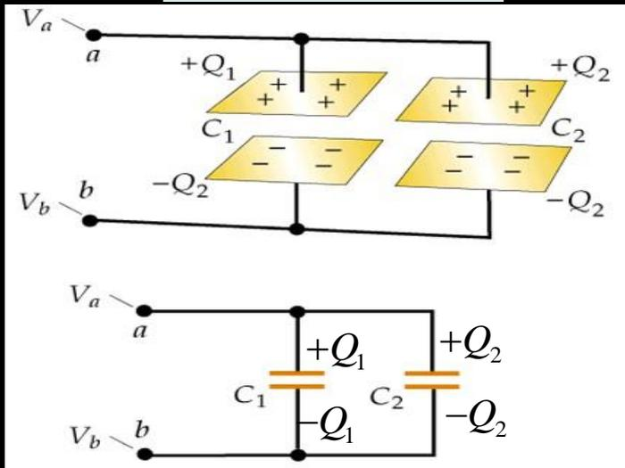
Energia eléctrica armazenada no Condensador
